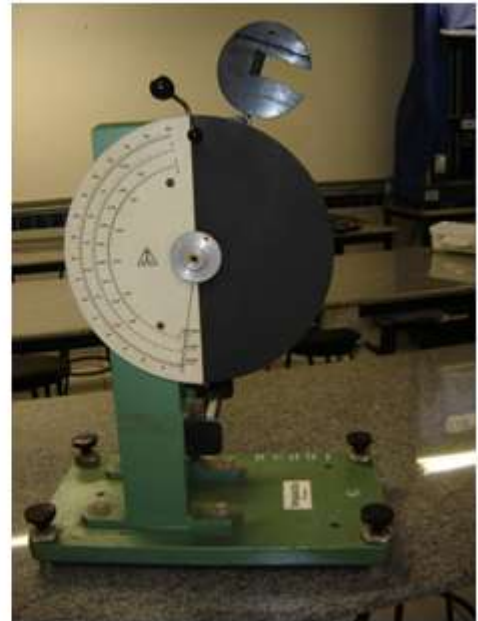
Figura 52- Dispositivo para ensaio Charpy do LPM.
