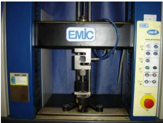
Figura 42 - Ensaio de Flexão a quatro pontos em corpos de prova cerâmicos.
