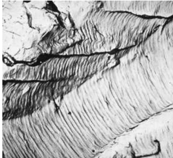
Figura 105 Fractografia eletrônica por transmissão mostrando estrias de fadiga no alumínio. [1]
