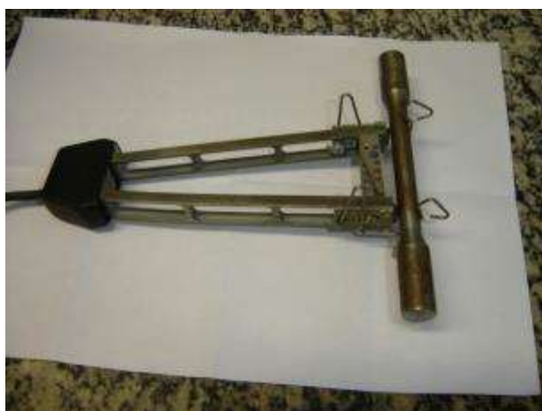
Figura 30 - Instalação de Extensômetro Clip Gage em Corpo de Prova.
