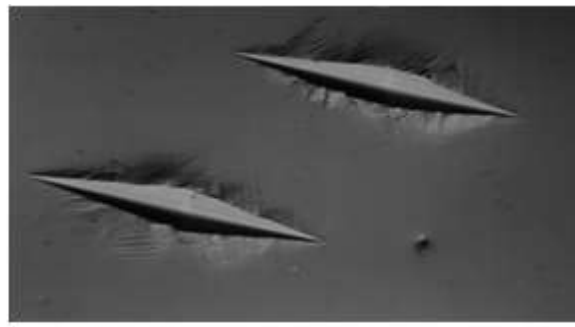
(b) indentação deixada no material
