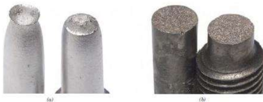
Figura 28 - (a) fratura dúctil e (b) fratura frágil [1]
