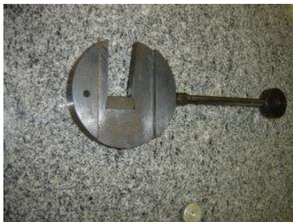
Figura 51 - Martelo para ensaio Charpy em corpos de prova de matérias poliméricas e plásticos.
