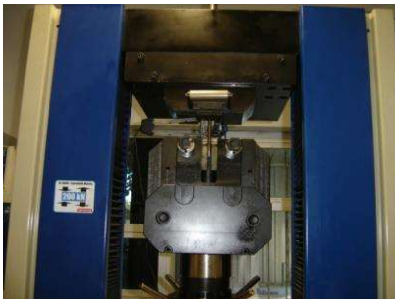
Figura 10 Corpo de Prova fixado na máquina para a realização de ensaio de tração.
