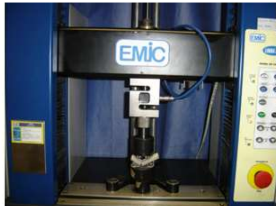
Figura 42 - Ensaio de Flexão a quatro pontos em corpos de prova cerâmicos.
