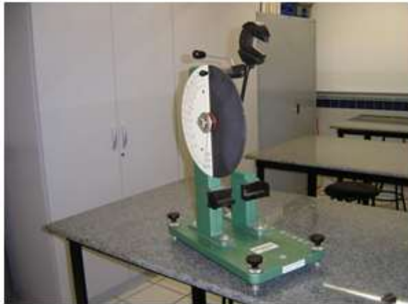
Figura 52- Dispositivo para ensaio Charpy do LPM.
