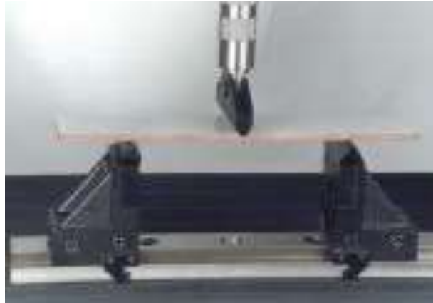
Figura 34 - Equipamento e corpo de prova no ensaio de flexão de três pontos.
